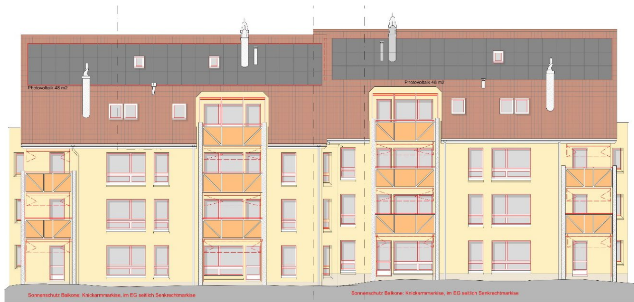
Fassadenbeispiel mit den eingezeichneten Sanierungsmassnahmen. (aktuell ist noch kein Farb- und Materialkonzept vorhanden)
