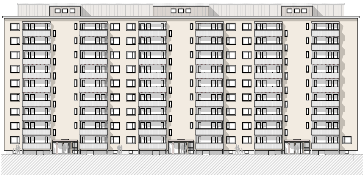
Ansicht Hirzenbachstrasse 48-52, mit der neuen fugenlosen Fassade, den grösseren Balkonen und dem neuen Attikageschoss anstatt des heutigen Walmdaches
